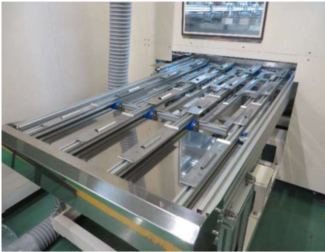
洗浄ワーク搬入口
